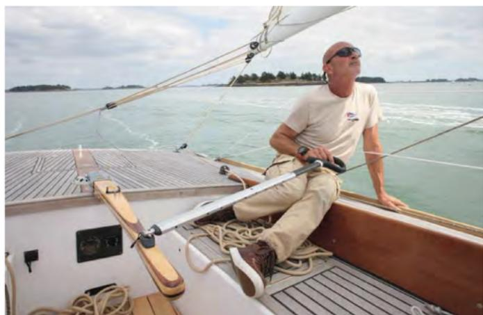
**Du bout du stick.** La barre est très neutre. Les deux safrans présentent l'avantage d'un tirant d'eau limité (la quille se relève) et d'un bon contrôle à la gîte.
