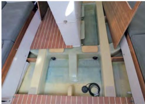
**Sérieux.** Il faut soulever les planchers pour apprécier la qualité de la construction : la structure transversale et longitudinale est impressionnante pour un bateau de cette taille. Tout le fond de coque est accessible.
