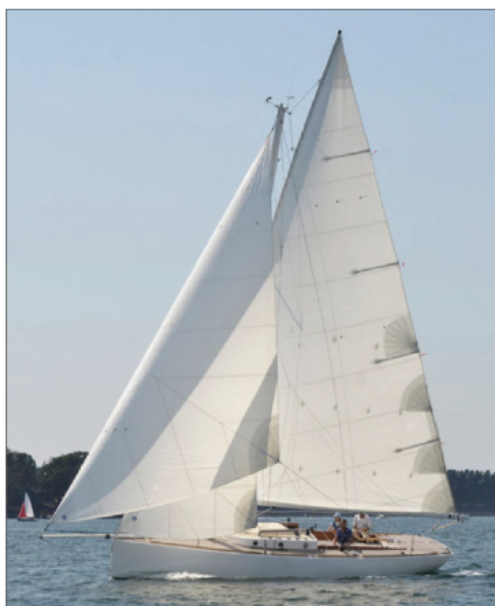
▲ La grand-voile s'élève à 16 mètres, et doit être arisée dès 15 nœuds de vent.
